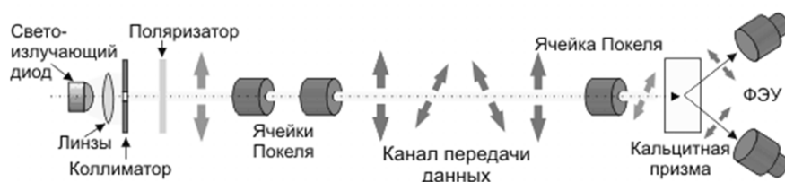
Рис. 1. Схема практической реализации квантовой криптографии
